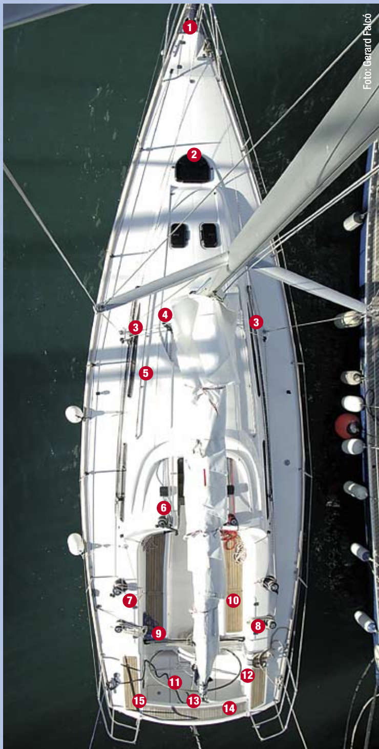
1. Enrollador de génova bajo cubierta; 2. Escotilla practicable; 3. Carros de génova; 4. Desviadrizas; 5. Pasamanos de inoxidable; 6. Winches de piano; 7. Winches de génova; 8. Winches de mayor; 9. Carro de mayor; 10. Cofre de bañera; 11. Rueda de timón; 12. Cuadro de mandos del motor; 13. Acceso al sector; 14. Bancada de popa extraíble; 15. Cofre del gas
