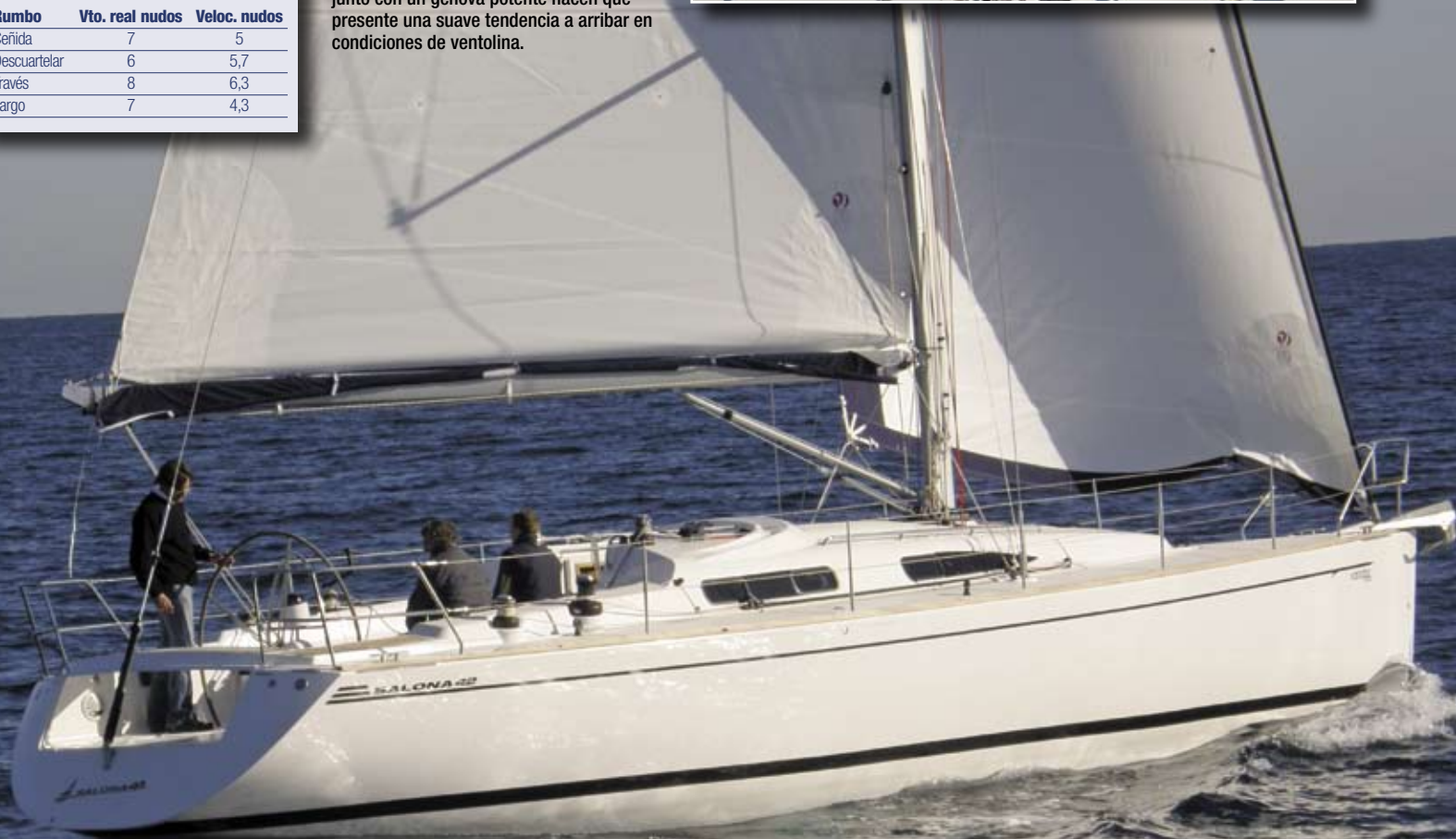
El paso hacia la proa es cómodo y seguro, gracias a una anchura de pasillo buena y a unos pasamanos robustos de inoxidable en el lateral de la cabina.
