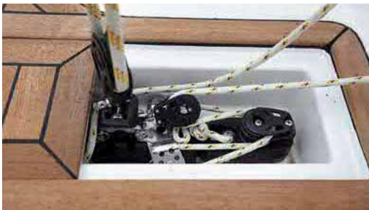
Barriere. Die Steuersäulen schränken die Bewegungsfreiheit ein. Der Traveller läuft versenkt, der Kanal wird im Hafen abgedeckt. Die beiden Räder lassen einen breiten Durchgang
